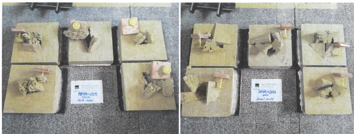
Zkušební tělesa 581/19 + 428/19 po zkoušce protažení kotev izolantem /Tested samples 581/19 + 428/19 after the Pull-through test of fixings /
